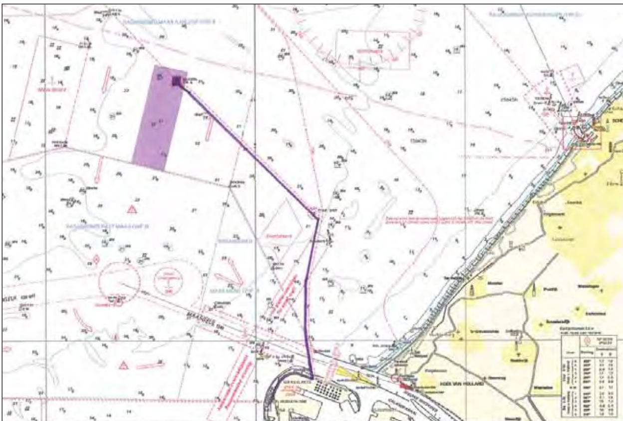
26 Figuur 8. Tracé buisleiding vanaf de Maasvlakte
